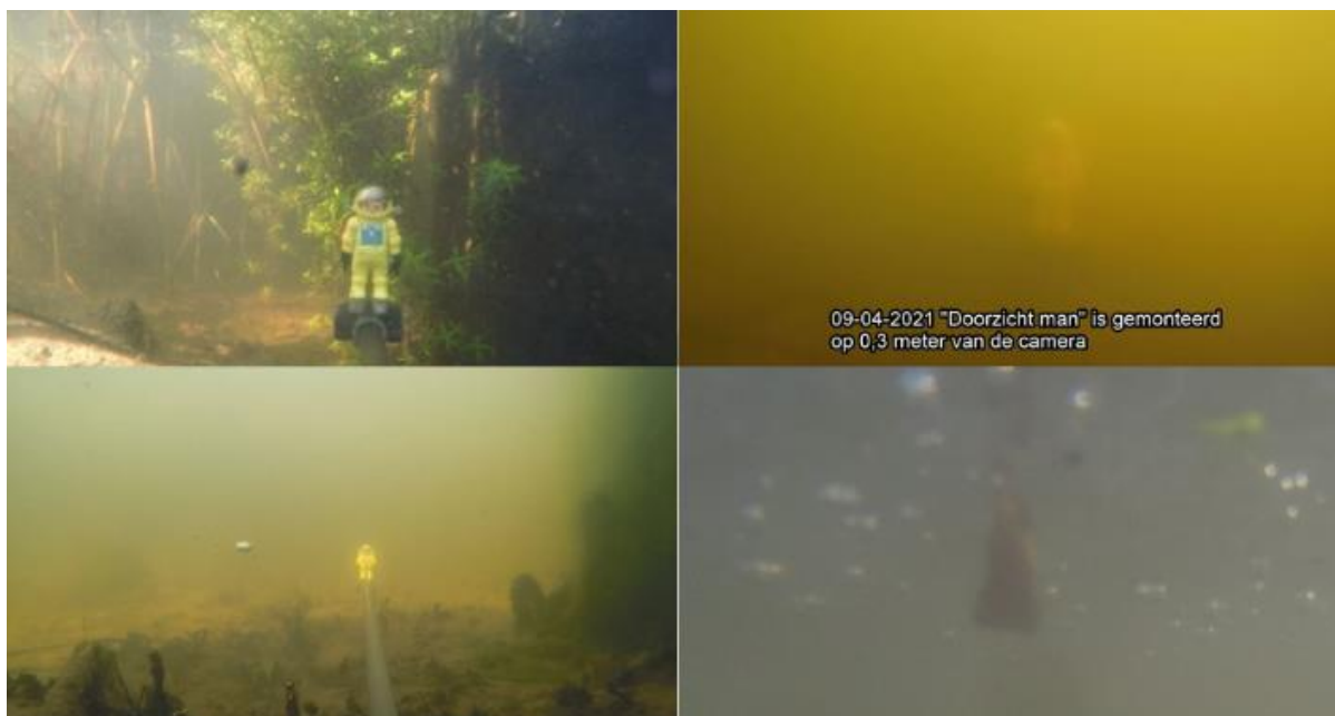
Afbeelding 4. Linksboven maart (voor plaatsing), rechtsboven april (na plaatsing, Doorzichtman op 30 cm), linksonder mei (Doorzichtman op 1,0 m), rechtsonder september (Doorzichtman op 30 cm)
