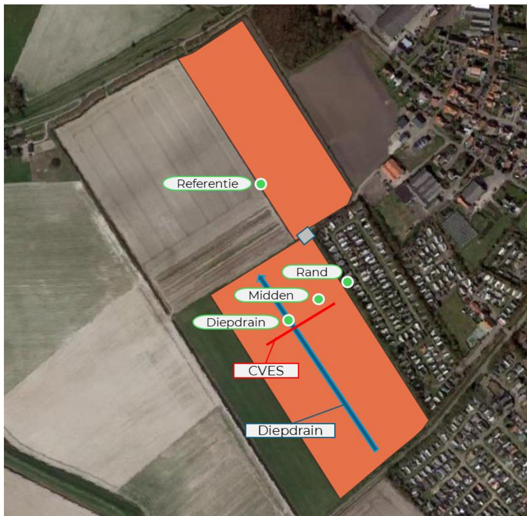
Afbeelding 2. Schematische weergave van de monitoring op het proefperceel. Te zien zijn de diepdrain (blauw), het traject voor de CVES-metingen (rood), de locaties van de peilbuizen (groen) en de regelunit (grijs)
